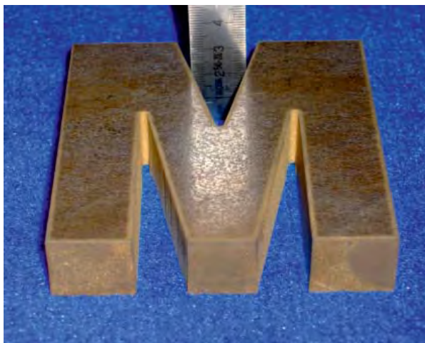
20 mm Messing, Oberfläche roh - Kanten gesandstrahlt
