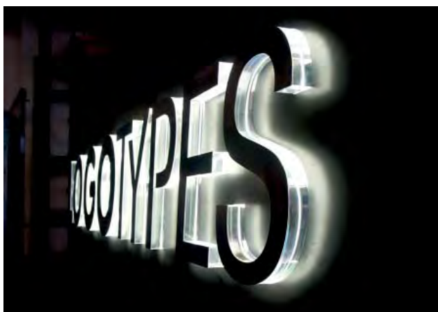
Sandwich: 20 mm farblos mit Front 1,5 mm V2a (in negativ ausgelasertem Blech mit Hinterleuchtung)
